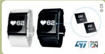
le bracelet PulseOn. Grâce à l'accéléromètre MEMS basse consommation et haute performance de ST, le bracelet PulseOn affiche le même niveau de fiabilité et de précision des mesures de fréquence cardiaque qu'un électrocardiogramme.
